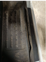
Kapı, sağ ön, Kapı fitili > Hasarlı
