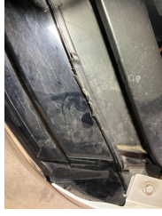
Farlar, Far camı, sol > Standart Dışı Onarım
