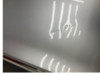
Kapı, sağ arka, Kapı, sağ arka > Ezik
