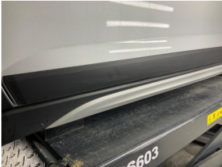
Kapı, sol ön, Kapı bandı > Çizik
