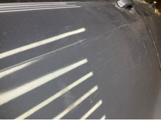
Kapı, sol ön, Kapı, sol ön > Çizik
