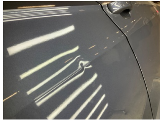
Kapı, sağ arka, Kapı, sağ arka > Ezik
