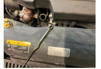
Motor, Yağ seviyesi > Eksik
