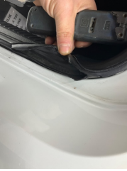
Arka bölüm, Bagaj kapağı fitili > Hasarlı
