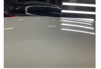
Tavan, Tavan > Dolu Hasarı
