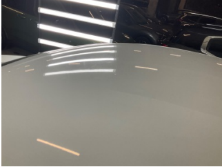
Tavan, Tavan > Dolu Hasarı
