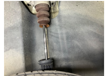
Arka aks, Amortisör körüğü, sol > Hasarlı
