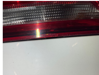
Arka lambalar, Arka lamba camı, sağ > Çatlak
