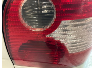
Arka lambalar, Arka lamba camı, sağ > Çatlak
