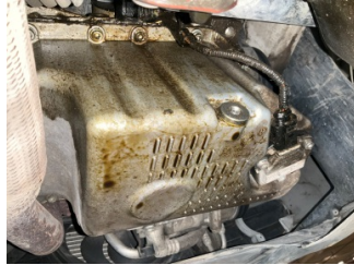
Motor, Motor > Yağ Kaçağı
