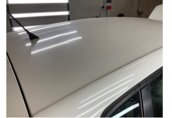
Tavan, Tavan > Dolu Hasarı
