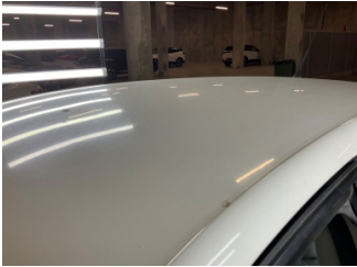
Tavan, Tavan > Dolu Hasarı
