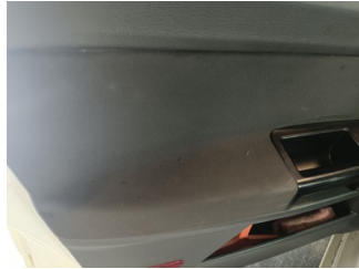
Döşemeler/Kapaklar, Döşemeler/Kapaklar > Yakıcı Madde ile Zarar Görmüş
