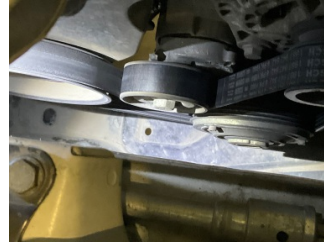
Motorsoğutması, Kayış > Çatlak
