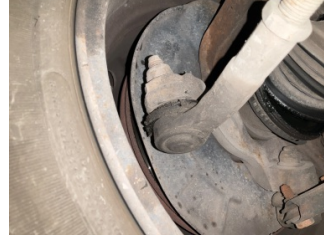
Direksiyon sistemi, Rot kolu/Rot başı, sol > Hasarlı
