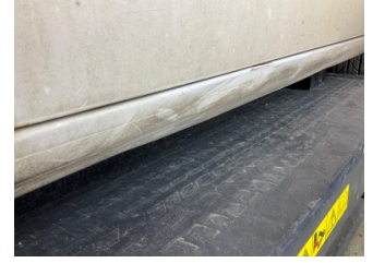
Marşbiyel, sağ, Marşbiyel, sağ > Hasarlı
