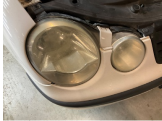
Farlar, Far camı, sağ > Deforme Olmuş
