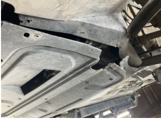
Motor, Alt muhafaza > Hasarlı
