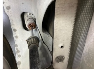
Arka aks, Amortisör körüğü, sol > Hasarlı
