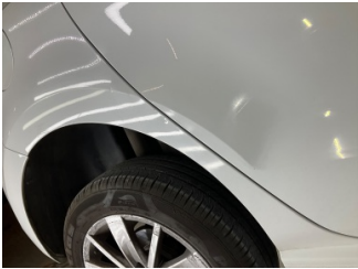
Çamurluk, sağ arka, Çamurluk, sağ arka > Ezik
