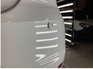
Tampon, arka, Park sensörü, sağ > Sabitlemesi Hatalı
