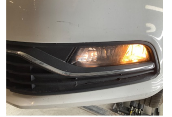
Sis lambaları, Sis ızgarası Sol > Hasarlı
