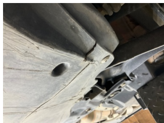
Motor, Alt muhafaza > Hasarlı
