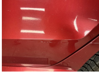
Kapı, sol arka, Kapı, sol arka > Çizik
