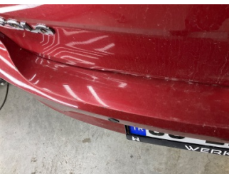
Tampon, arka, Arka tampon > Çatlak
