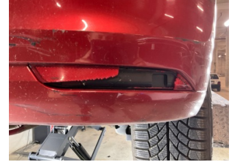
Tampon, arka, Reflektör, sağ > Hasarlı
