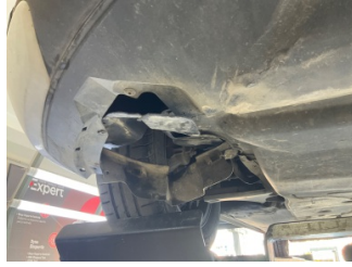
Motor, Alt muhafaza > Hasarlı
