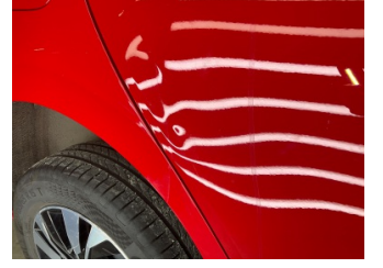
Kapı, sağ arka, Kapı, sağ arka > Ezik
