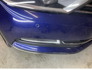
Tampon, ön, Ön tampon > Taş Izi
