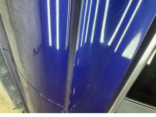
Kapı, sağ arka, Kapı, sağ arka > Çizik
