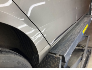
Kapı, sağ arka, Kapı, sağ arka > Ezik
