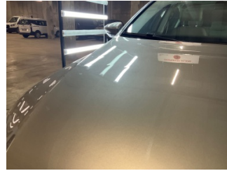
Motor kaputu, Motor kaputu > Dolu Hasarlı
