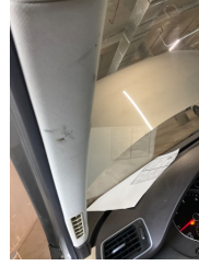
Döşemeler/Kapaklar, Döşemeler/Kapaklar > Yakıcı Madde Ile Zarar Görmüş
