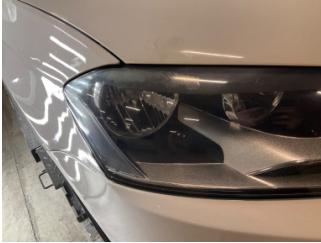
Farlar, Far camı, sağ > Deforme Olmuş
