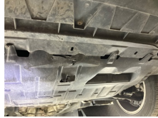
Motor, Alt muhafaza > Hasarlı
