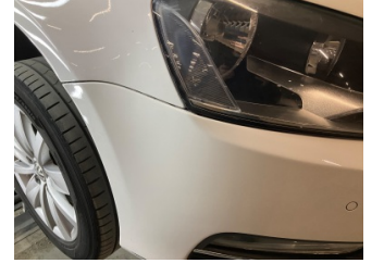
Tampon, ön, Ön tampon > Sabitlemesi Hatalı
