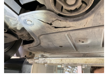
Motor, Alt muhafaza > Hasarlı
