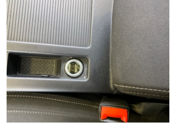
Elektrik donanımı/Pano, Çakmak > Sökülmüş-Yok
