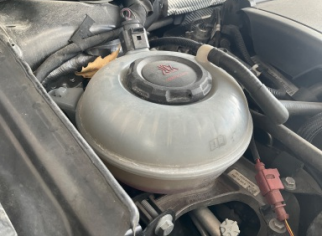
Motorsoğutması, Soğutma sıvısı > Eksik
