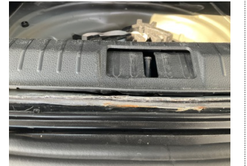
Arka bölüm, Arka sac/panel > Hasarlı
