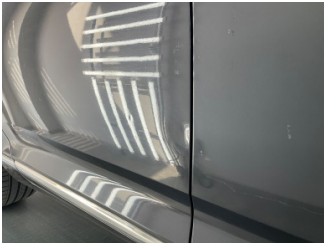
Kapı, sağ arka, Kapı, sağ arka > Ezik
