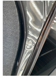
Bagaj kapağı/kapısı, Bagaj kapısı > Ezik
