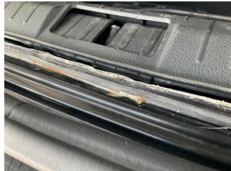
Arka bölüm, Arka sac/panel > Standart Dışı Onarım
