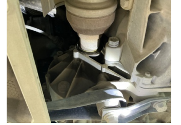
Ön aks, Aks mili, sağ > Yağ Kaçağı
