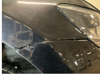
Tampon, ön, Ön tampon > Sabitlemesi Hatalı
