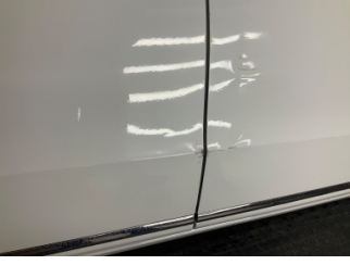
Kapı, sağ arka, Kapı, sağ arka > Ezik
