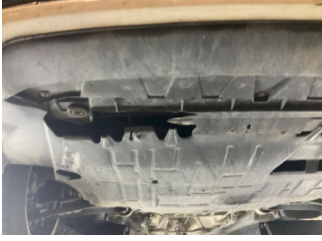
Motor, Alt muhafaza > Hasarlı
