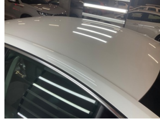
Tavan, Tavan > Dolu Hasarlı
