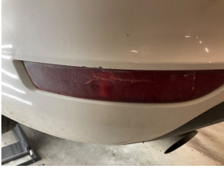
Tampon, arka, Reflektör, sol > Hasarlı
