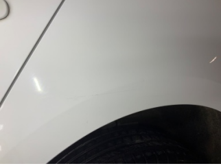
Çamurluk, sol arka, Çamurluk, sol arka > Çizik
