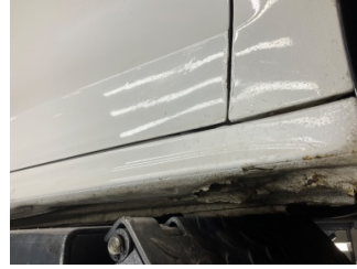
Marşbiyel, sağ, Marşbiyel, sağ > Hasarlı
