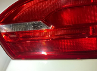
Arka lambalar, Arka lamba camı, sağ > Çatlak
