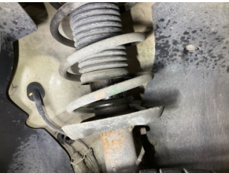
Ön aks, Amortisör, ön sağ > Yağ Kaçağı
