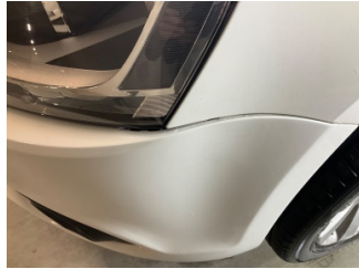
Tampon, ön, Ön tampon > Sabitlemesi Hatalı
