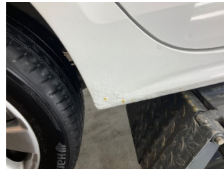
Marşbiyel, sağ, Marşbiyel, sağ > Pas
