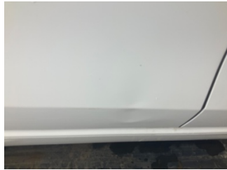
Kapı, sağ arka, Kapı, sağ arka > Ezik
