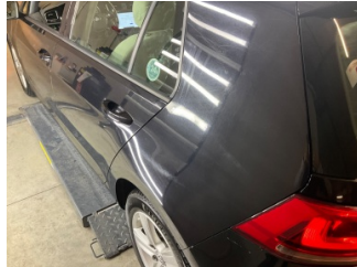
Çamurluk, sol arka, Çamurluk, sol arka > Çizik
