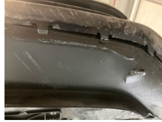
Tampon, ön, Tampon koruyucu orta > Hasarlı
