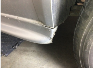
Marşbiyel, sol, Marşbiyel plastiği, sol > Hasarlı
