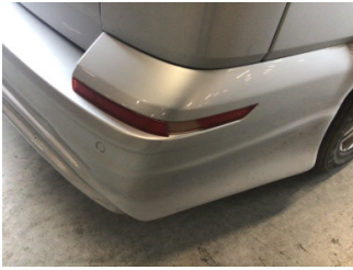
Tampon, arka, Reflektör, sağ > Hasarlı
