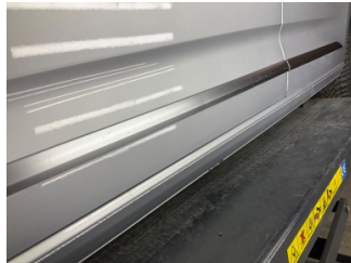
Kapı, sol ön, Kapı, sol ön > Ezik
