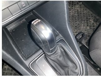
Şanzıman, Vites topuzu > Deforme Olmuş
