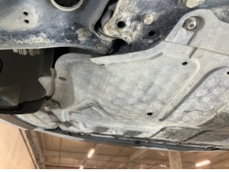
Motor, Alt muhafaza > Hasarlı
