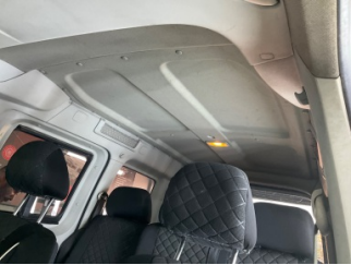
Döşemeler/Kapaklar, Döşemeler/Kapaklar > Kirlenmiş
