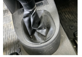
Döşemeler/Kapaklar, Döşemeler/Kapaklar > Deforme Olmuş
