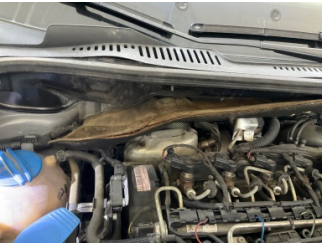
Motor, Motor izolasyonu > Deforme Olmuş
