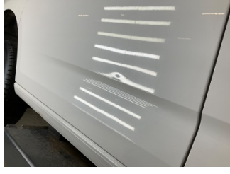
Kapı, sağ arka, Kapı, sağ arka > Vuruk
