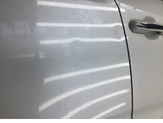
Kapı, sağ arka, Kapı, sağ arka > Ezik
