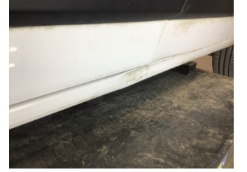
Marşbiyel, sol, Marşbiyel, sol > Hasarlı
