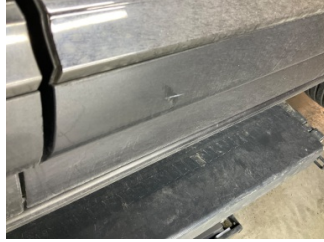
Kapı, sol arka, Kapı bandı > Çizik
