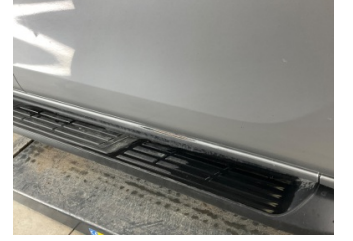
Marşbiyel, sağ, Marşbiyel, sağ > Boyası Atmış
