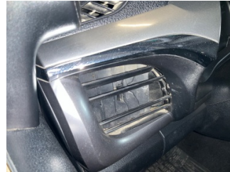
Kalorifer/Klima, Havalandırma ızgarası > Hasarlı
