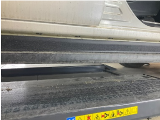
Marşbiyel, sağ, Marşbiyel plastığı, sağ > Çizik
