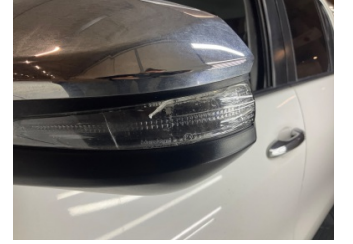
Dikiz aynası, sol, Sinyal lambası > Çatlak
