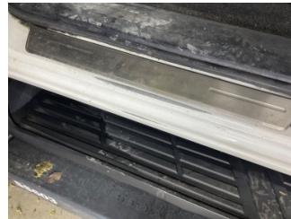
Marşbiyel, sol, Marşbiyel, sol > Boyası Atmış
