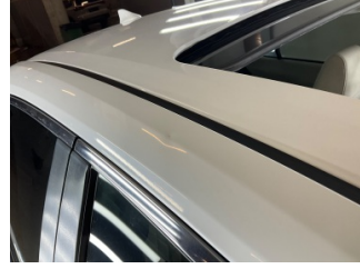
Kaporta, Sağ Üst Frangart > Noktasal Ezik
