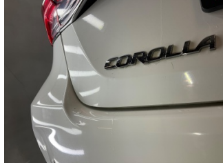
Bagaj kapağı/kapısı, Bagaj kapısı > Noktasal Ezik
