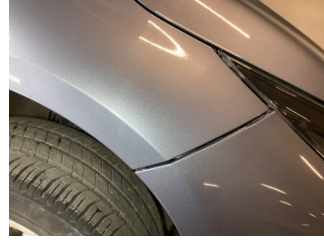
Tampon, ön, Ön tampon > Sabitlemesi Hatalı
