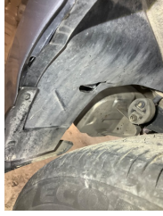
Çamurluk, sağ arka, Davlumbaz > Kırılmış
