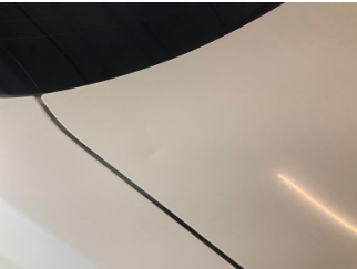
Bagaj kapağı/kapısı, Bagaj kapısı > Ezik
