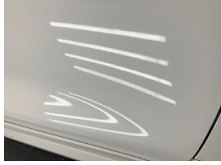
Kapı, sağ ön, Kapı, sağ ön > Çizik
