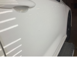
Kapı, sağ ön, Kapı, sağ ön > Çizik
