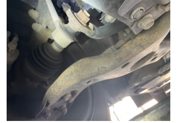
Ön aks, Denge çubuğu, ön > Hasarlı
