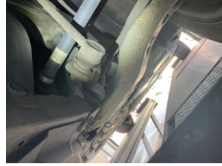
Ön aks, Denge çubuğu, ön > Hasarlı
