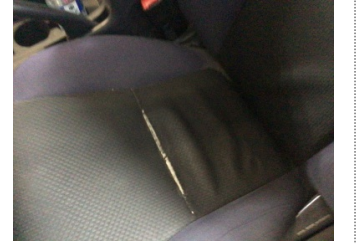
Koltuklar, ön, Koltuk arkılığı döşemesi, sol ön > Hasarlı
