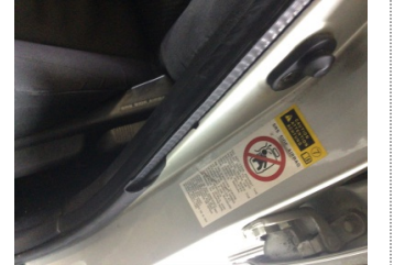
Kapı, sağ ön, Kapı fitili > Hasarlı
