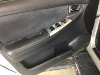
Döşemeler/Kapaklar, iç döşemesi, sol > Deforme Olmuş
