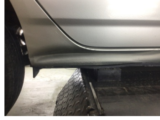
Marşbiyel, sağ, Marşbiyel, sağ > Hasarlı
