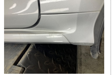
Marşbiyel, sağ, Marşbiyel plastiği, sağ > Hasarlı
