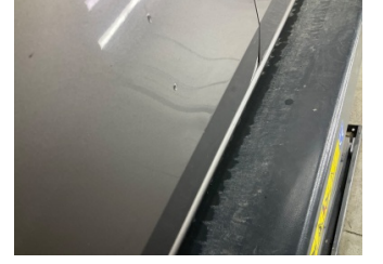
Kapı, sol ön, Kapı, sol > Ezik
