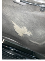
Motor kaputu, İzolasyon döşemesi > Hasarlı
