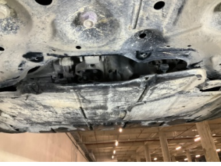
Motor, Alt muhafaza > Hasarlı
