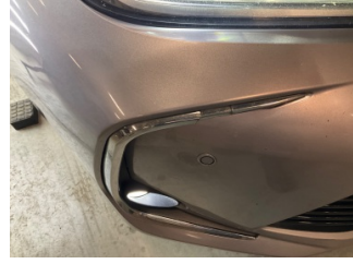
Sis lambaları, Sis Izgarası Sağ > Hasarlı
