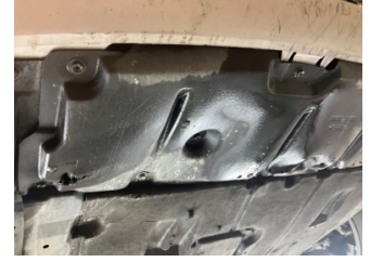
Tampon, ön, Tampon koruyucu orta > Hasarlı
