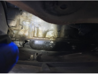
Motor, Motor > Yağ Kaçağı
