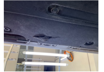
Kaporta, Muhafaza, orta > Hasarlı
