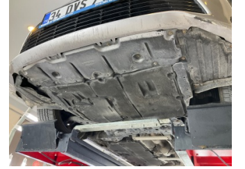
Motor, Alt muhafaza > Hasarlı
