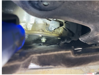
Motor, Motor > Yağ Kaçağı
