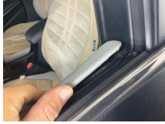
Döşemeler/Kapaklar, Kapı döşemesi, sol ön > Sabitlemesi Hatalı
