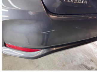
Tampon, arka, Arka tampon > Küçük Çizik
